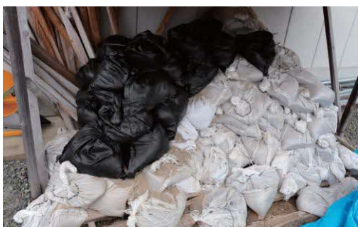
過去に購入した白い土のう袋は劣化し、破れやすかったため、補助制度を利用して耐久性のある黒いUV土のう袋を購入し、上からかぶせて活用している。
