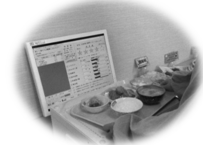
～食育 SAT システム (体験型栄養教育システム)～ フードモデルを選んでセンサーに載せるだけで、栄養価計算とその食事のバランスがチェックできる。
