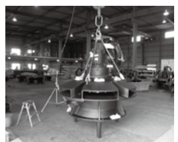
氷上工場で製造される大型のばっ気攪拌装置
