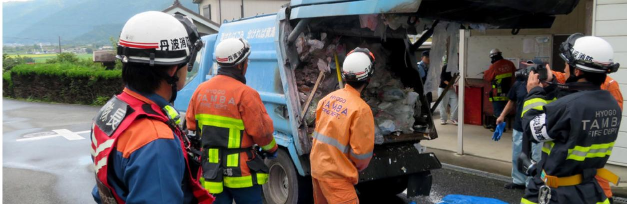
プラスチック系ごみ袋の中に携帯電話とパソコン用マウス(乾電池式)が混入していたことで、収集車両に積載したごみが燃える事故の発生現場
