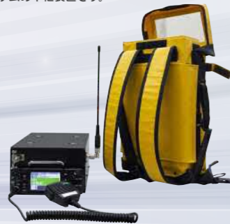
可搬型移動局無線装置
