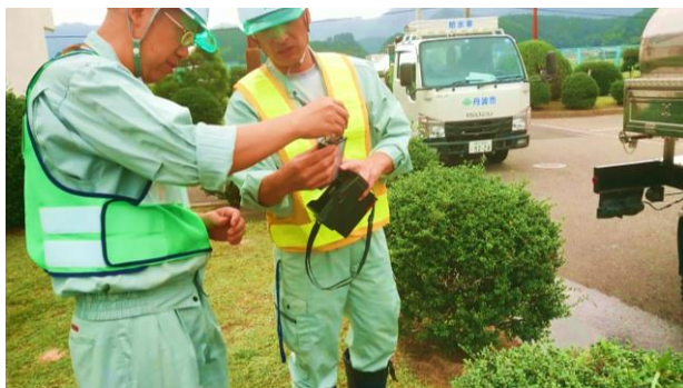
充水する水道水の残留塩素濃度を確認している様子①
