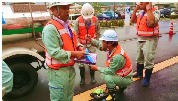
充水している水道水の残留塩素濃度を確認している様子
