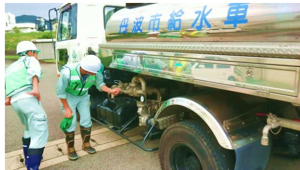
給水車の切り替えレバーを確認している様子
