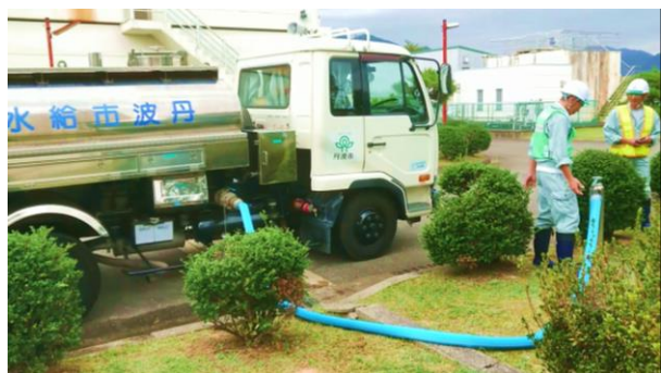
給水車に充水している様子
