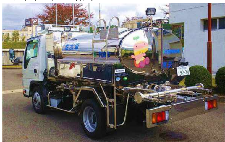
○給水車と組立式給水タンク
