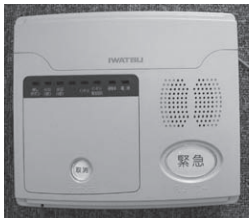
△緊急通報機器（本体）
