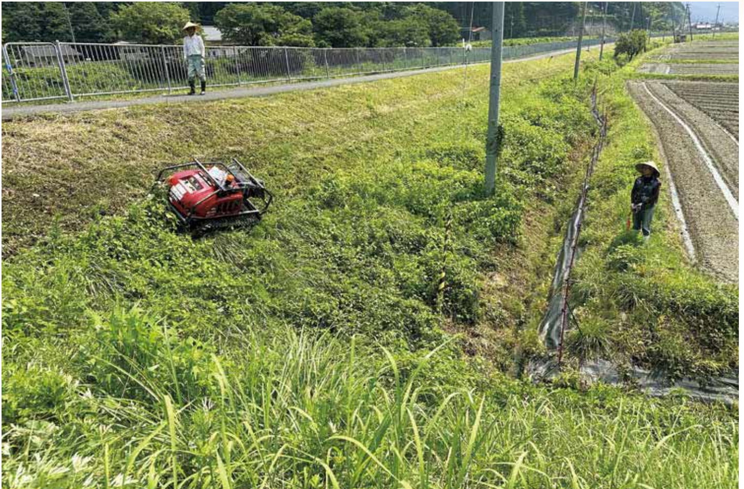
【青垣町小倉 ラジコン式草刈機で法面を除草作業する様子】
